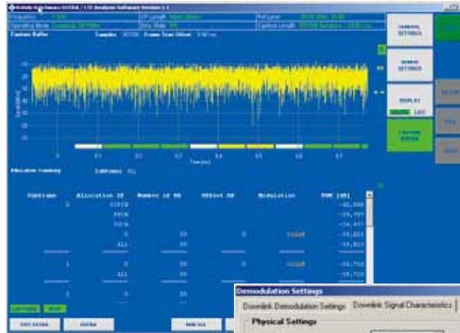
屏幕的上部通过不同颜色显示了信号的功率，以便识别信号的重要部分，如 P-SCH。屏幕的下部显示了资源块及其调制质量的概要。
